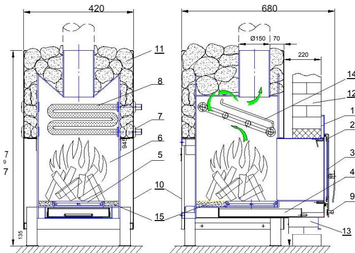
**Рис.1.** 1. Передняя панель. 2. Дверцы. 3. Стекло. 4. Ящик для пепла. 5. Колосник. 6. Очаг топки. 7. Крышка. 8. Теплообменник. 9. Заслонка на подаче воздуха. 10. Отделочные щиты. 11. Камни. 12. Стена бани. 13. Каменная вата S30...50. 14. Рассекатель огня. 15. Вермикулит.
