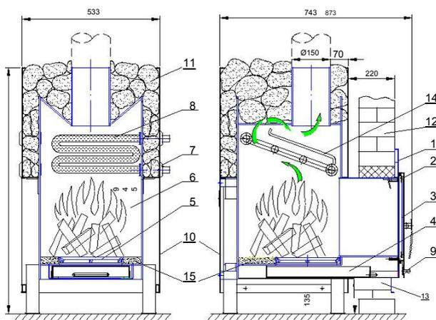
**Рис.1.** 1. Передняя панель. 2. Дверцы. 3. Стекло. 4. Ящик для пепла. 5. Колосник. 6. Очаг топки. 7. Крышка. 8. Теплообменник. 9. Заслонка на подаче воздуха. 10. Отделочные щиты. 11. Камни. 12. Стена бани. 13. Каменная вата S30...50. 14. Рассекатель огня. 15. Вермикулит.
